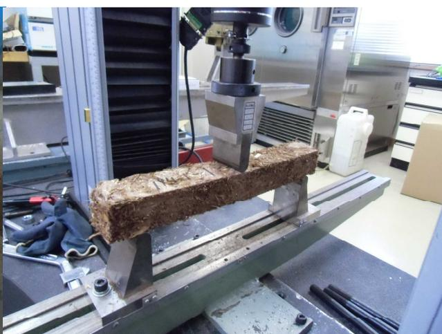
写真2 曲げ強さ試験状況
