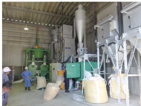
写真 高規格木粉製造ライン（左：原料乾燥機、右：篩い・粉碎・集塵ライン）
