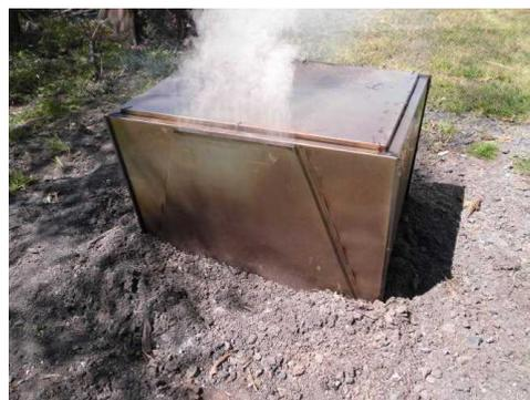
写真 斜め煙道式炭化炉
