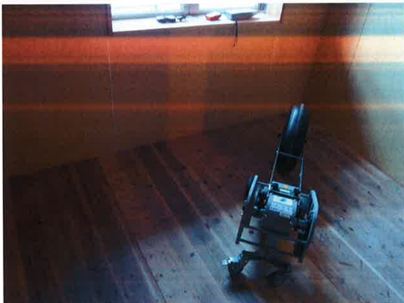
写真 3 2F 客室(音源側)床仕上げ前 標準重量床衝撃源(バングマシン)
