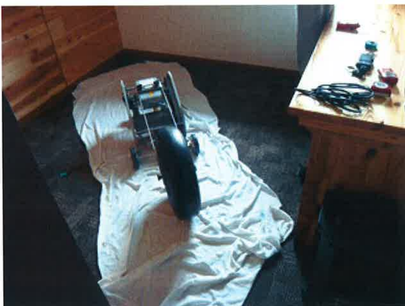
写真 4 2F 客室(音源側)竣工後 標準重量床衝撃源(バングマシン)
