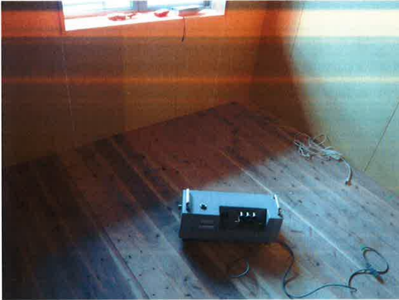
写真1 2F 客室(音源側)床仕上げ前 標準軽量床衝撃源(タッピングマシン)
