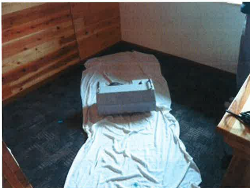
写真2 2F 客室(音源側)竣工後 標準軽量床衝撃源(タッピングマシン)
