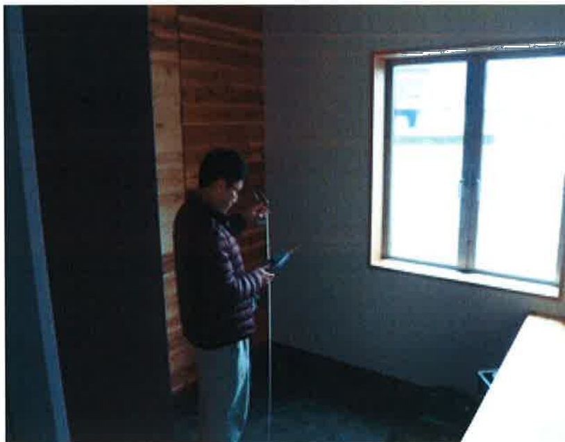
写真6 1F 客室(受音側)竣工後 測定
