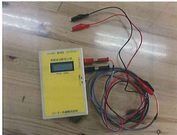
写真 2.3 木材水分計センサ (KNS-GWS)
