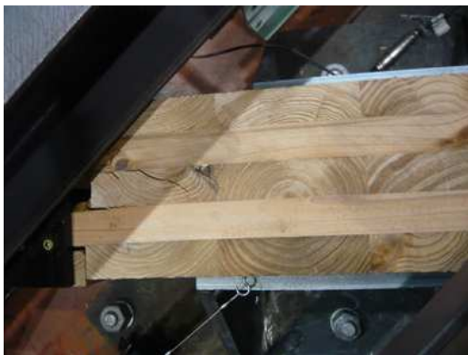
写真 3.3.1 実験 3 の破壊状況 (接合角度 45°)
