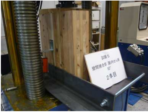
写真 2.4.3 実験 4 の装置全景 (接合角度 90°)
