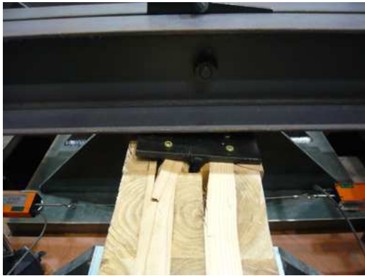
写真 3.3.3 実験 3 の破壊状況 (接合角度 90° )
