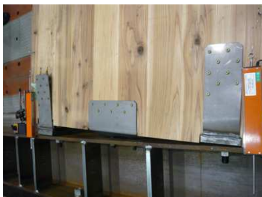
写真 3.1.1 実験 1 (矩形パネル) の脚部の変形状況
