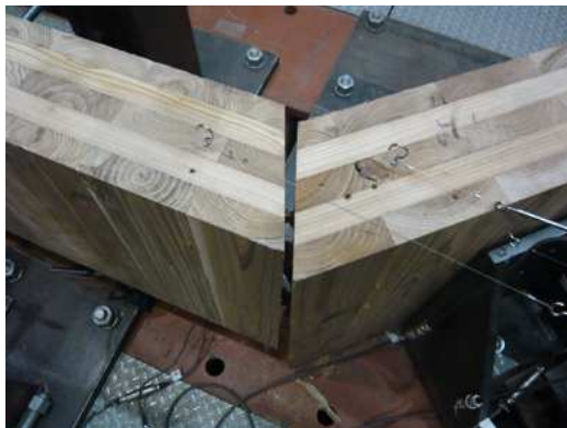
写真 3.5.1 実験 5 の破壊状況 (接合角度 45°)
