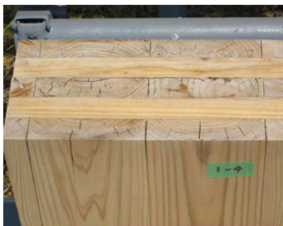
図 11 上端面における多数の割れ
