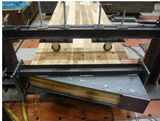
写真 2. 1. 2 実験 1 (台形壁) の加力治具
