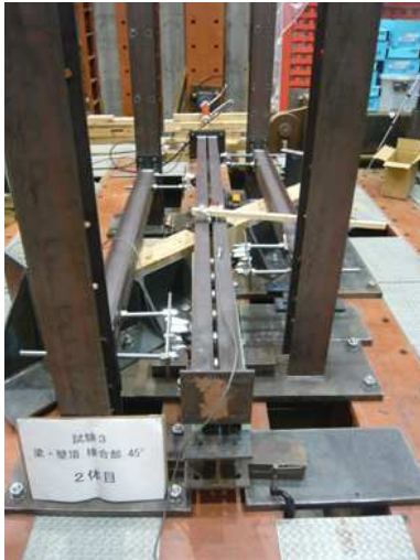
写真 2.3.1 実験 3 の装置全景 (接合角度 45° )
