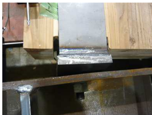
写真 3.1.2 実験 1 (矩形パネル) の引張金物の変形状況
