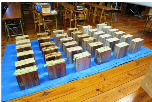
図3 試験体の屋内における養生
