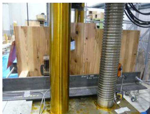
写真 2.4.2 実験 4 の装置全景 (接合角度 45°)
