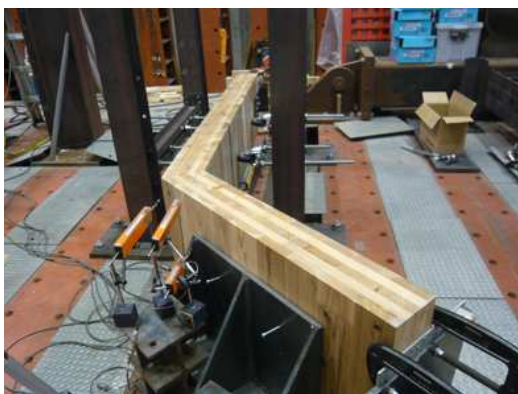
写真 2.5.1 実験 5 の装置全景 (接合角度 45°)
