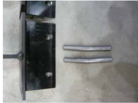
写真 3.3.6 実験 3 の金物の状況 (接合角度 90° )
