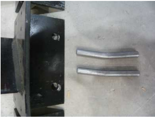
写真 3.3.5 実験 3 の金物の状況 (接合角度 45° )
