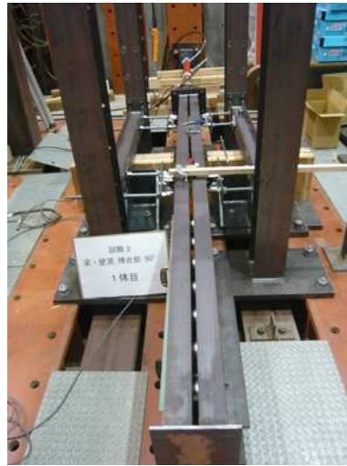
写真 2.3.2 実験 3 の装置全景 (接合角度 90° )
