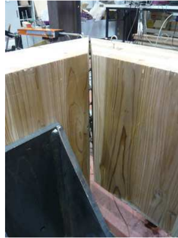
写真 3.5.4 実験 5 の破壊状況 (写真 3.5.3 の側面)
