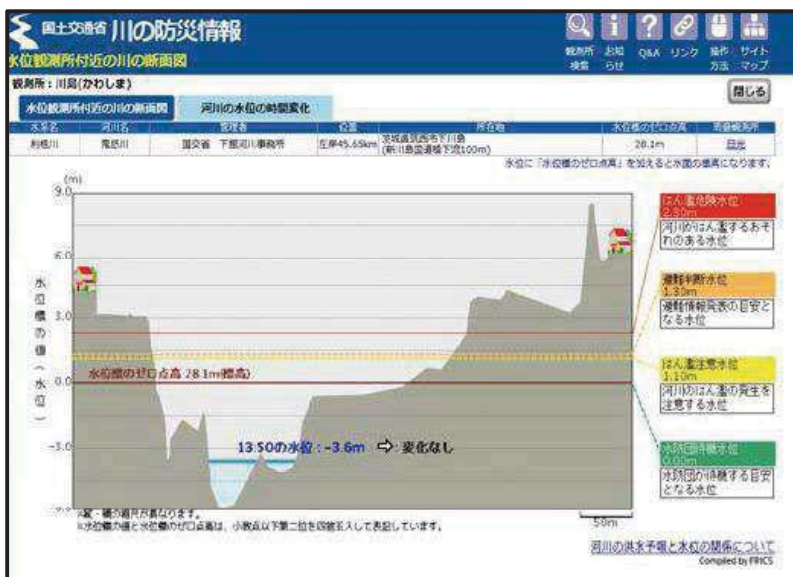
水位観測所付近の川の断面図
