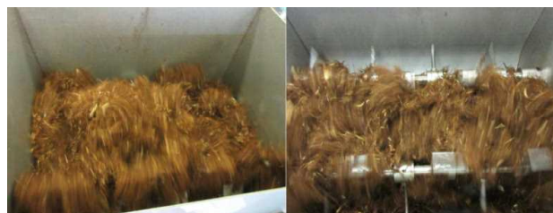
図-3 改良した羽根による攪拌状況
