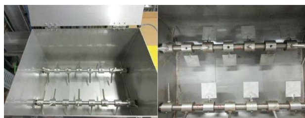
図-2 改良した混練装置の羽根の状況
