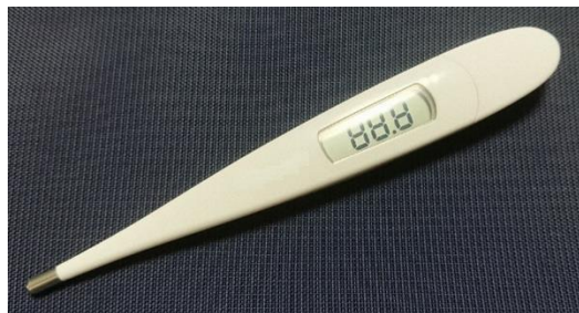
図2-1 接触型温度計（体温計）
