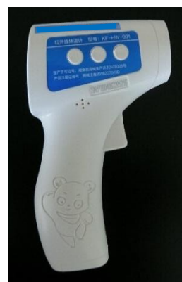
図2-2 非接触型温度計（体温計）
