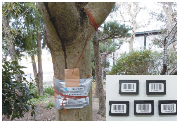
写真1：設置状況（蛍光ガラス線量計）
