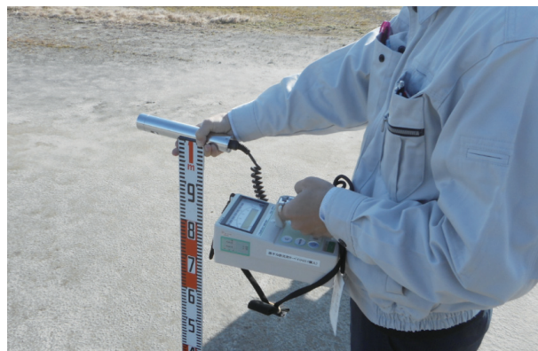
写真2：NaIシンチレーション式サーベイメータによる測定
