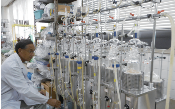
写真3：前処理（水蒸気蒸留）の様子（ふっ素濃度分析）
