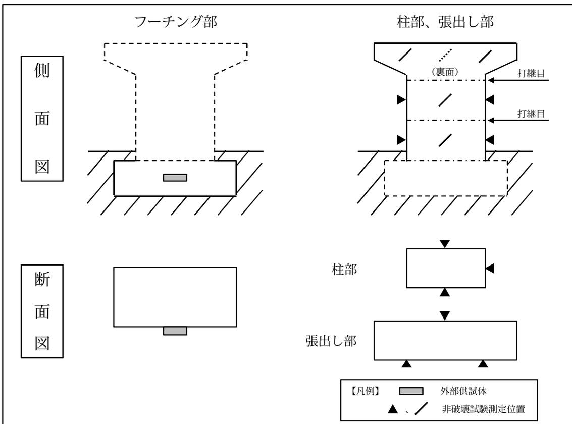
図4 橋梁下部構造の測定位置 (例)
