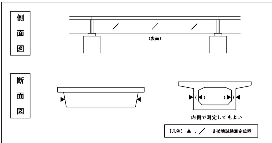
図3 橋梁上部構造の測定位置 (例)
