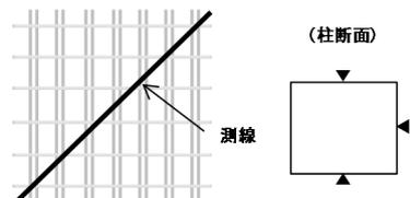
図 鉄筋に対する測線設定例
