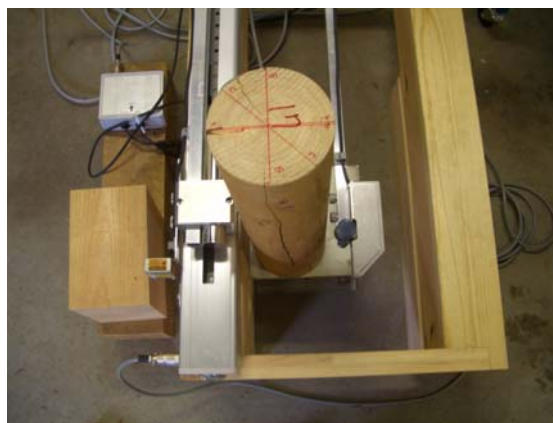
写真2 ガンマ線透過量調査状況
