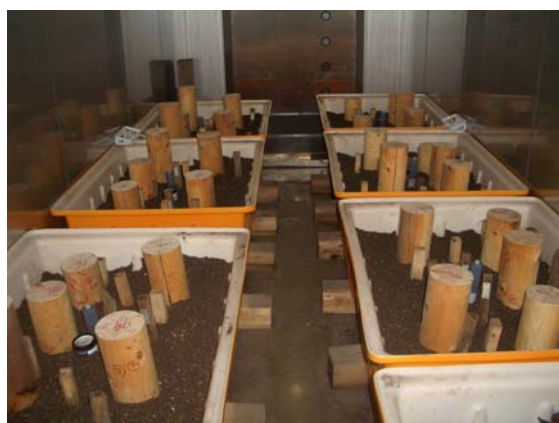
写真1 室内腐朽促進試験状況
