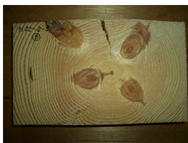
写真1 材面割れの発生形態
