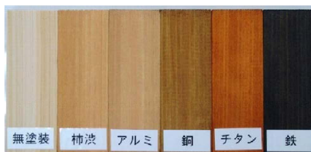
図 各種金属イオン添加による発色傾向
