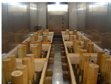
写真 室内腐朽促進試験状況
