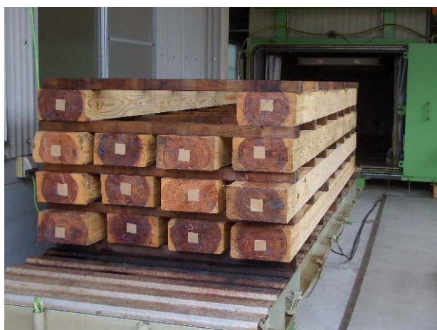
写真2 乾燥実験に用いたスギ平角材
