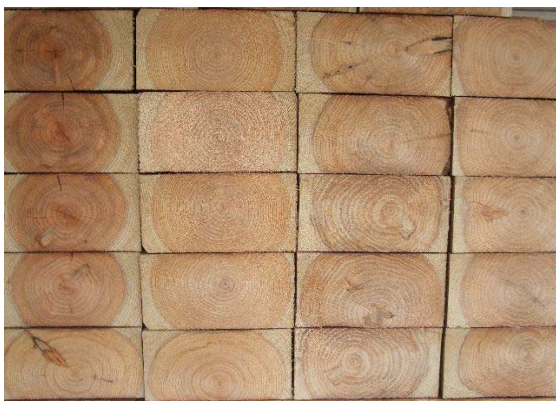
写真 18 スギ平角材 乾燥後の切断面
