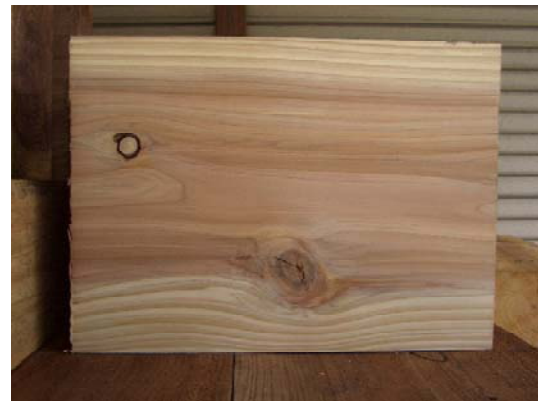
写真 19 材色測定 乾燥後の仕上げ材面
