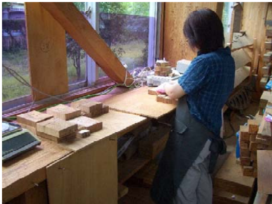
写真 16 分割試片の含水率の測定
