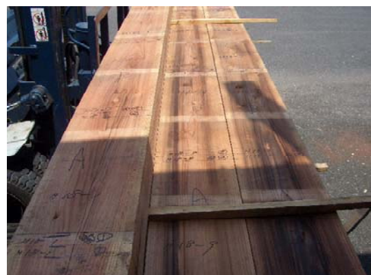
写真11 材面割れの測定
