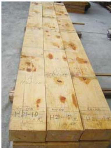
写真5 木口割れと材面割れ (発生量が多い)
