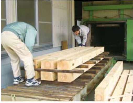
写真1 栈積みの状況
