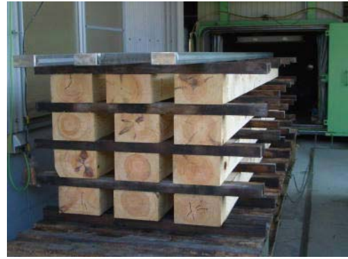
写真2 完成した栈積みロット
