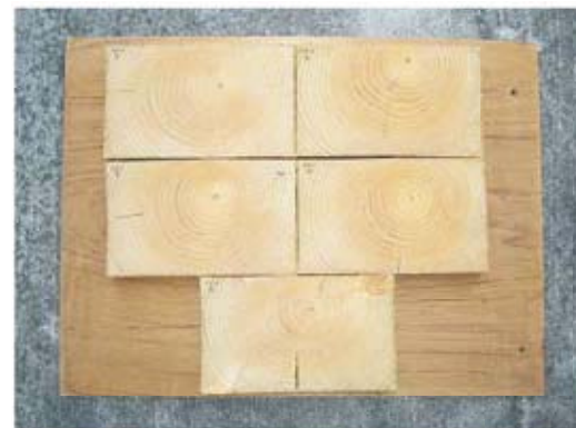
写真6 切断面における割れの状態 (内部割れの発生は少ない)
