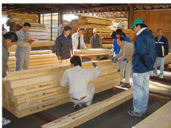
写真3 含水率・曲がりなどの測定
