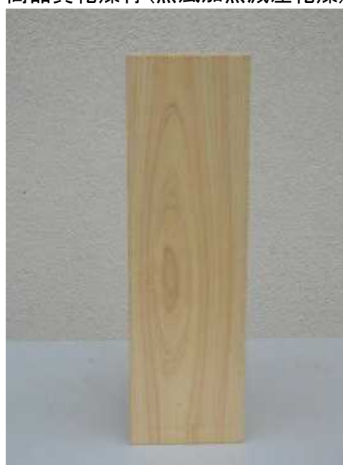
割れ・変色がない
