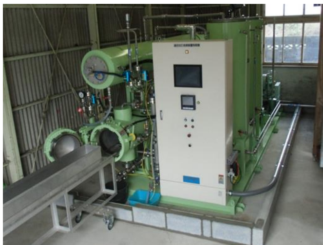
図1 薬剤注入処理に使用した真空・加圧含浸装置
