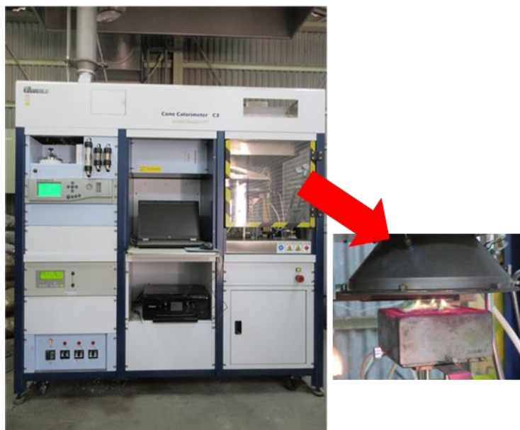
図2 コーンカロリメータによる発熱性試験
