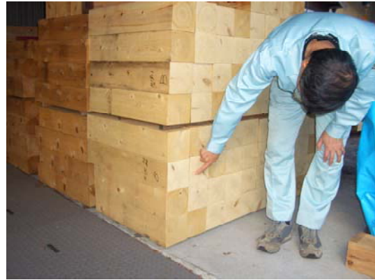
写真 14 割れ、変色のチェック
