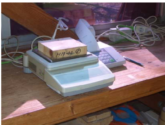
写真 17 全乾重量法による含水率の測定
