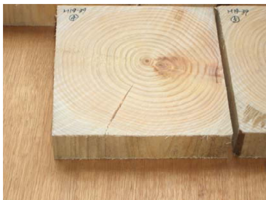
写真11 材面割れの閉塞の状態
