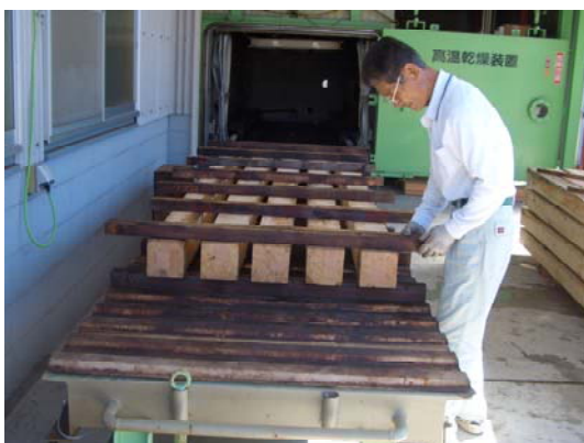
写真5 栈積みの状況
