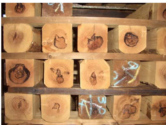
写真2-3 乾燥材の仕上がり状態
