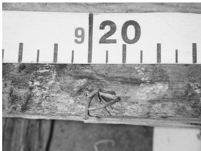
写真-6 同左カミキリ蛹室入口。 カミキリの木屑がみられる。
