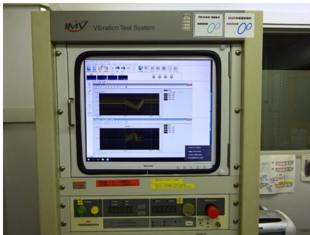
(a) 制御装置 (導入装置)
