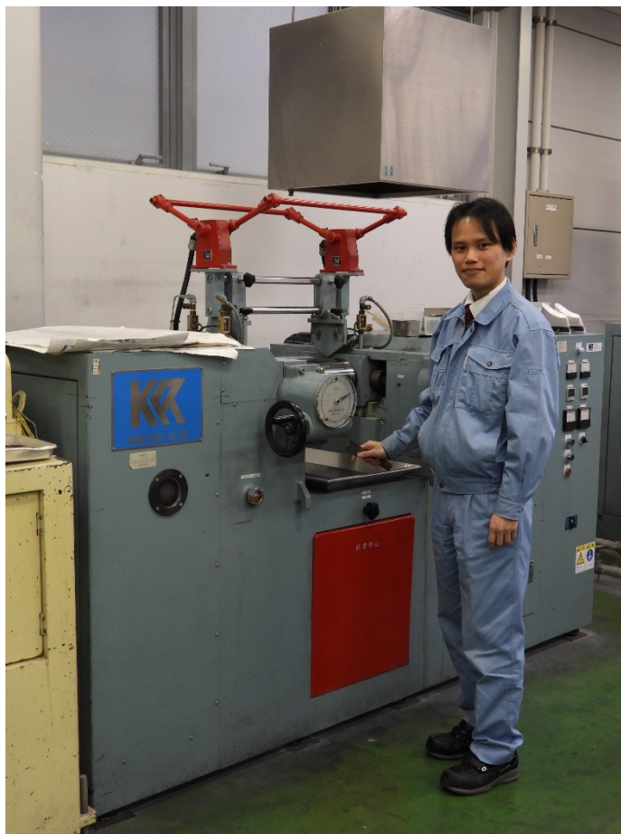
ロールを用いたゴムの加工作業
