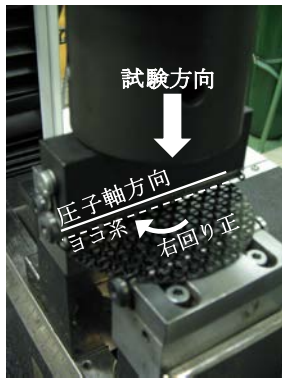
図2 円形試験片による3点曲げ試験
