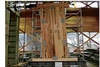
CLT 壁面の強度試験
