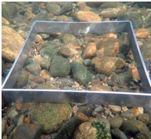
平方枠(コドラート)を用いた礫のサンプリング
