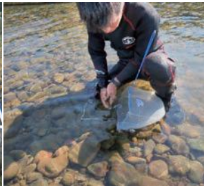
平方枠(コドラート)を用いた礫のサンプリング
