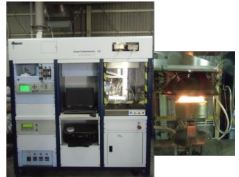
コーンカロリメーターによる燃焼試験
