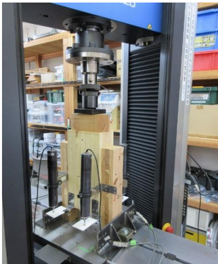
小型万能材料試験機による接合強度試験
