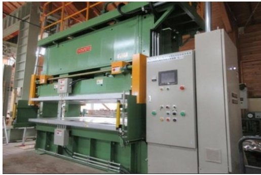
熱圧処理装置
