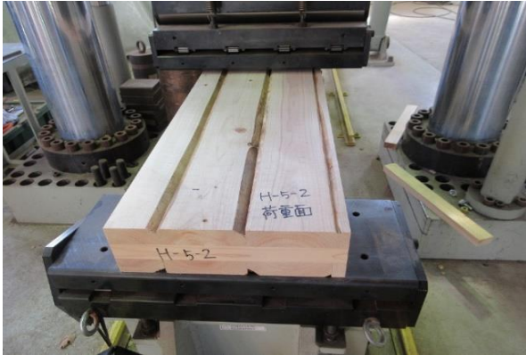
実大試験機によるCLT曲げ試験
