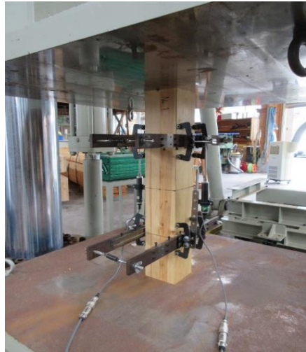
実大試験機による集成材縦圧縮試験
