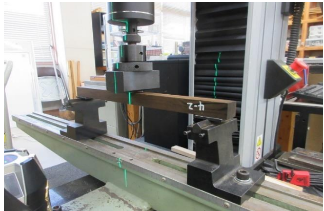
小型万能材料試験機による曲げ試験
