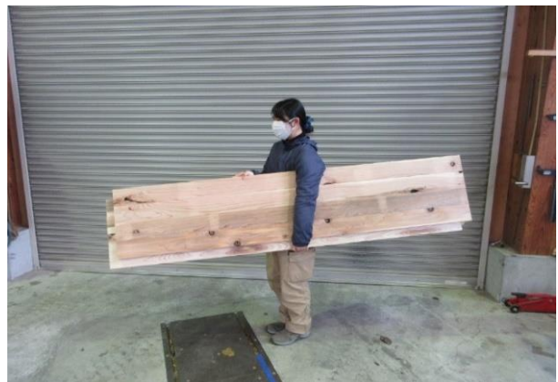
軽量な木製残存型枠用2層パネル
