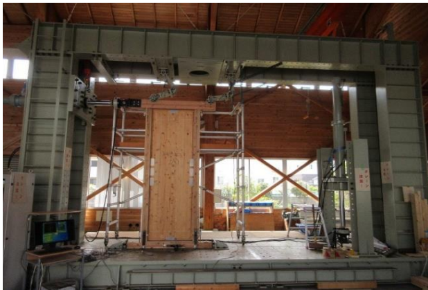
壁せん断試験機による壁せん断試験
