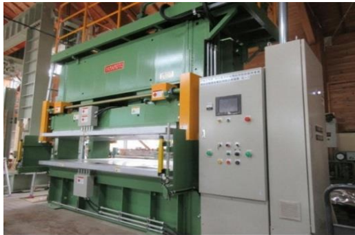
熱圧処理装置
