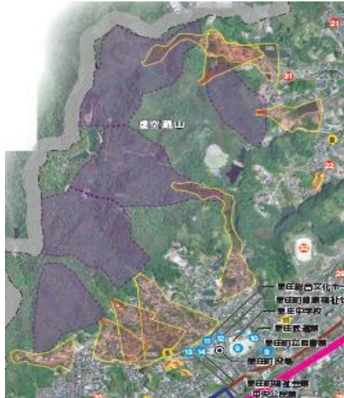
(里見地区で集中している土砂災害警戒区域)
