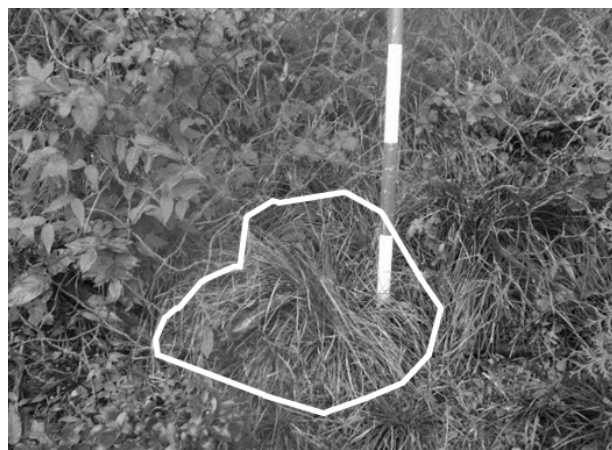
図-12 鳥獣によるネットの破れ
