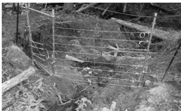
図-11 耐水害性機能調査用ロープ柵
