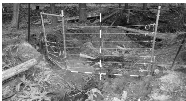
図-19 耐水害性機能調査用ロープ柵(設置時)
