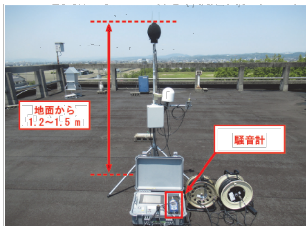
写真 航空機騒音自動測定装置
