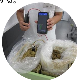
Bluetooth送信式 土壌水分計の製作
