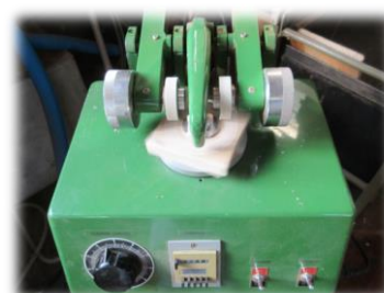
図6 材質試験の一例(摩耗試験)
