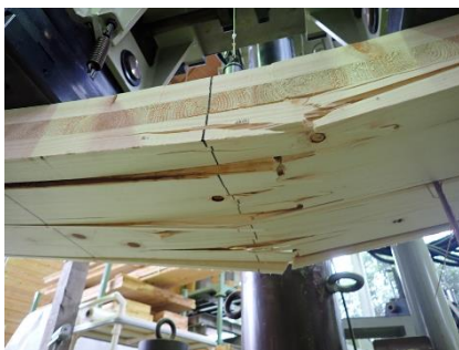
図2 面外曲げ試験後の破壊状況
