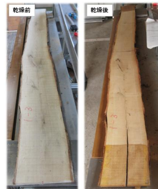
図 3 乾燥による木口割れ
