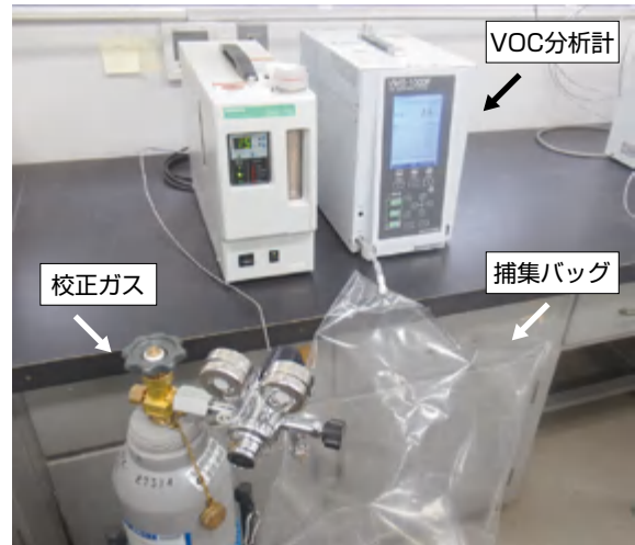
写真2 排ガス中のVOCの検査の様子
