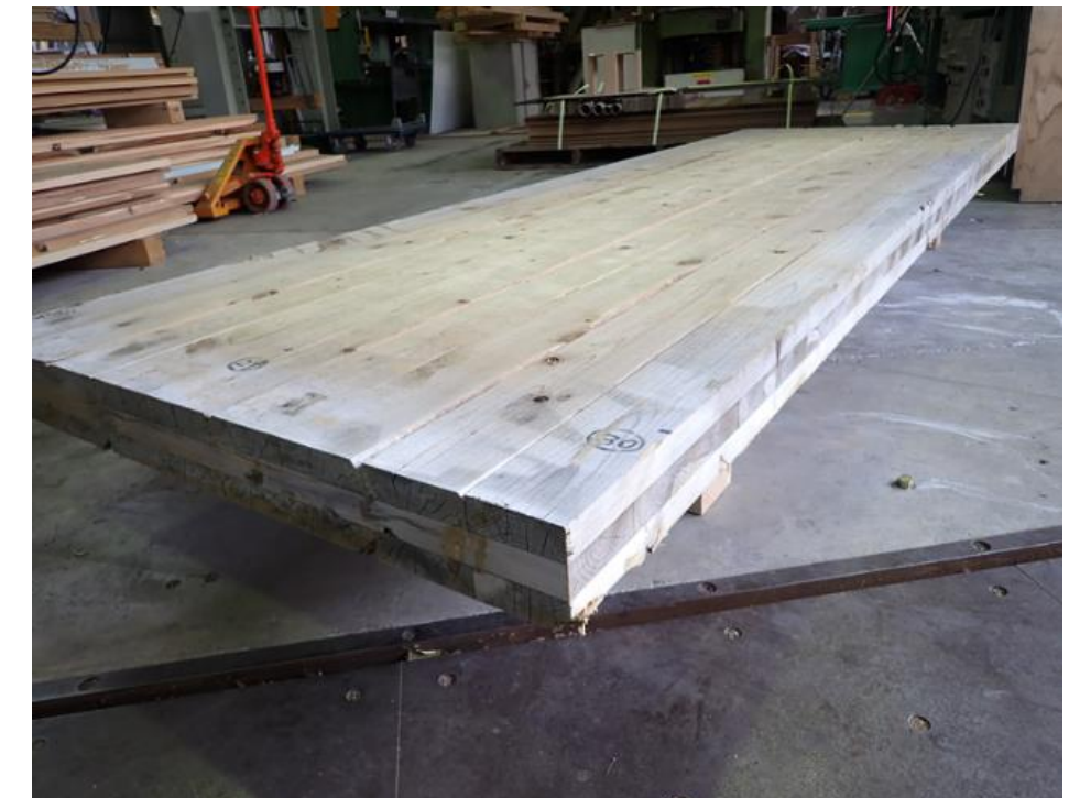
使用後のCLTの状況
