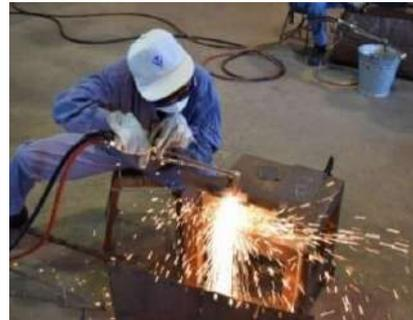
【ガス溶接、溶断実習】
