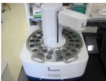
写真2 味覚センサー 人間の舌の構造を模した特殊なセンサーにより、うま味、酸味などの味の濃淡を数値で表すことができます。
