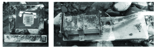
図4 試験終了直後の水中カメラの外観
