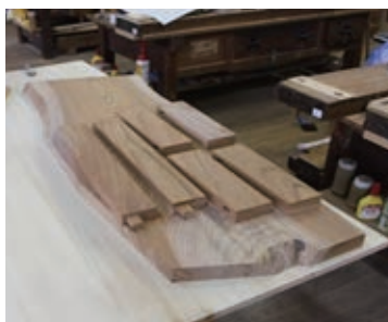
木取り (材木から必要な部材を取出します)
