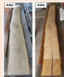
乾燥による木口割れ
