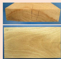
100℃試験による初期割れ状況 (上:木口割れ、下:表面割れ)
