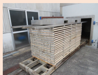
柾目木取りで採材したコナラ板材の棧積み状況
