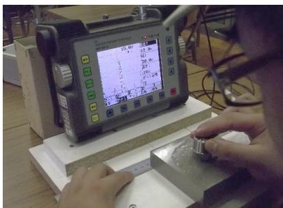
【破壊検査、非破壊検査実習】
