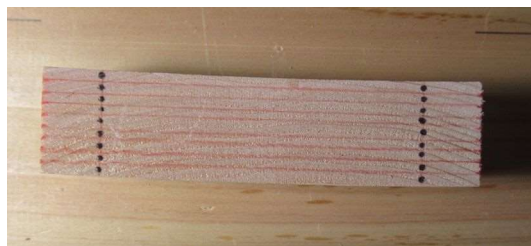
図－3 解放ひずみ傾斜測定用試験片の例
