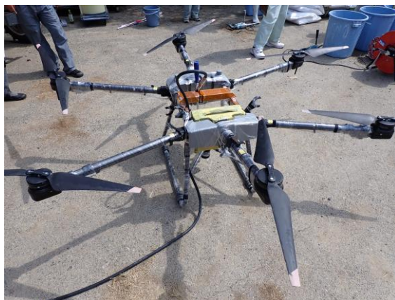
散布に使用したドローン (DJI Agras T30)
