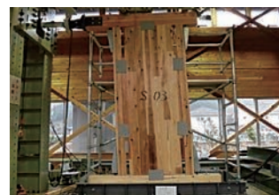
CLT 壁面の強度試験
