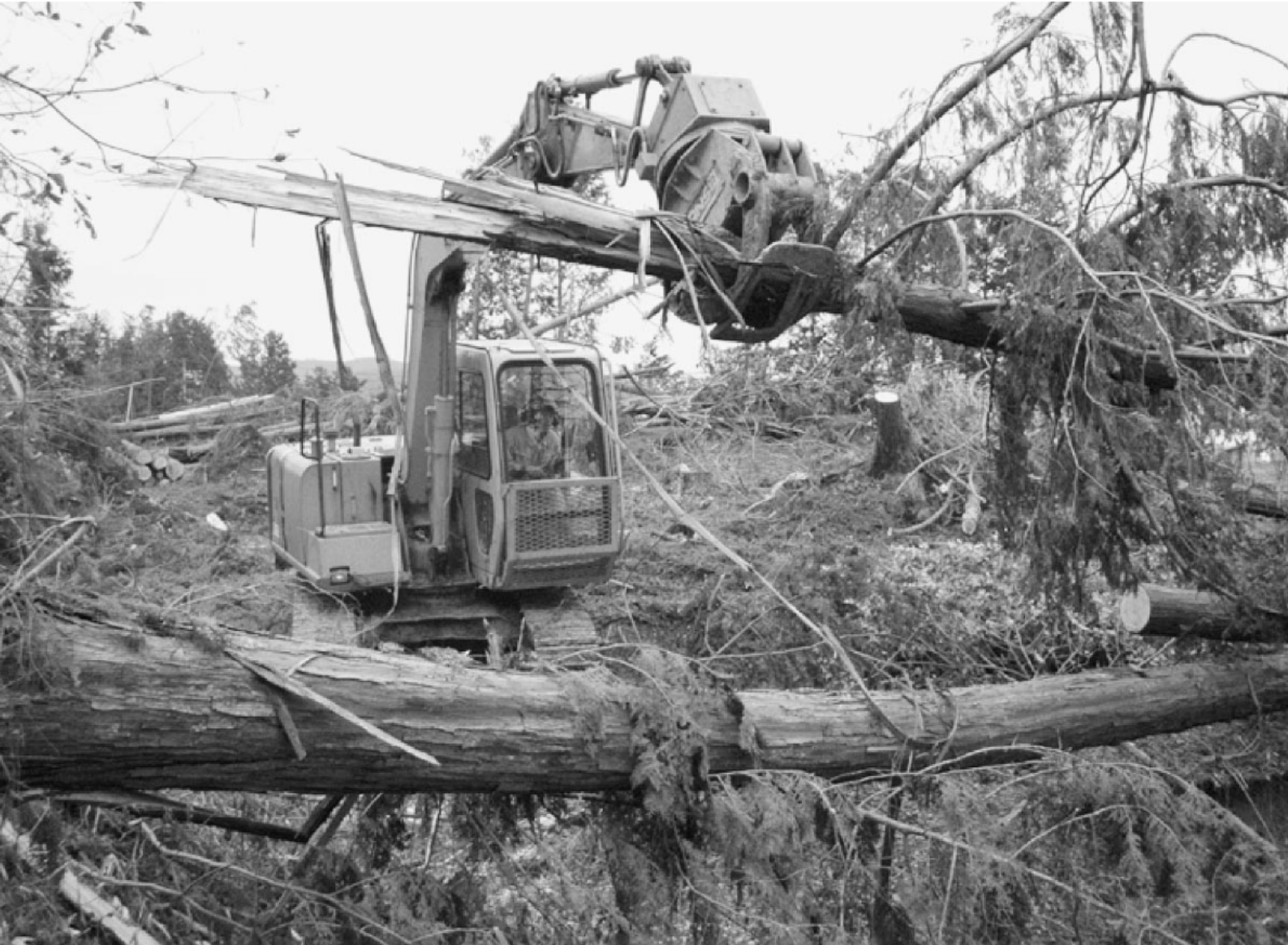
高性能林業機械の導入により進む風倒木処理（奈義町広岡地内）
