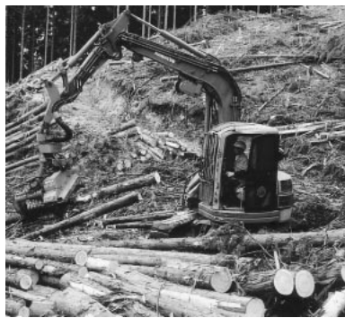
小旋回型プロセッサで効率よく造材
