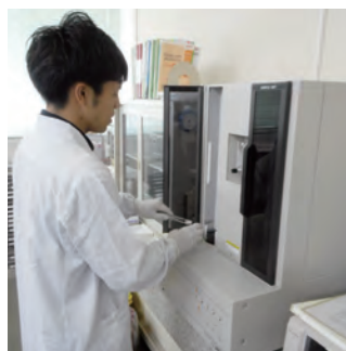
ラジウムを測定する アルファ線自動測定装置
