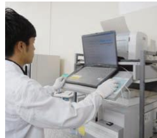
空間ガンマ線を測定する 蛍光ガラス線量計の測定装置
