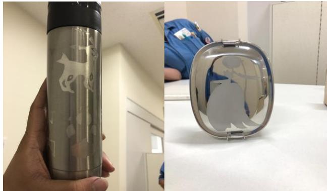
左の写真はガラスの粒子を使ってブラスト加工したもので、右はセラミック粒子で加工したものであり、その仕上がりには違いがあります。素材だけでなく、サイズにも違いがありました。セラミック粒子のブラスト加工の方が、写真でもおわかりのように、ほとんど失敗なくできあがったので、ガラス粒子のものよりも使いやすいです。
