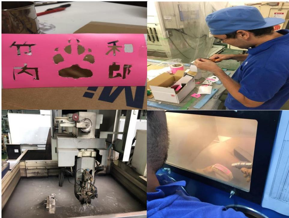
上は使用したマスキングテープと、ブラスト加工の準備、EDM 機器、ブラスト加工の作業中の写真です。下は出来上がったものの写真です。
