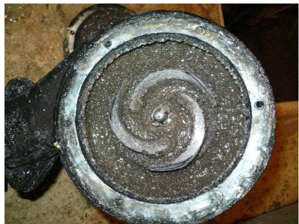
図11 水中ポンプインペラ部に付着した結晶化物
