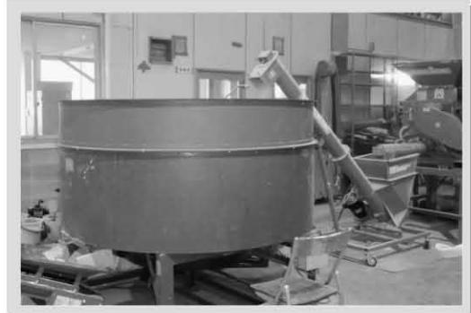
稻SGS調製機械（左：攪拌機、右：破碎機）
